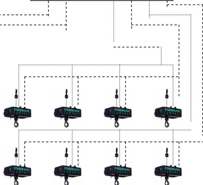
CABLAGE SEPARÉ POUR ALIMENTATION ET COMMANDE SEPERATE CABLING FOR POWER AND CONTROL
