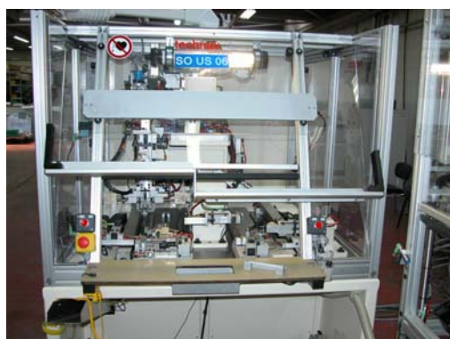
Poste opérateur avec outillage de soudage et outillage de contrôle
