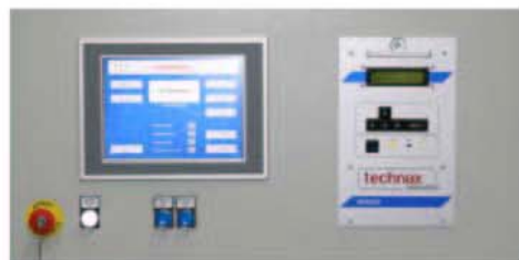
Ecran tactile et séquence de soudage
