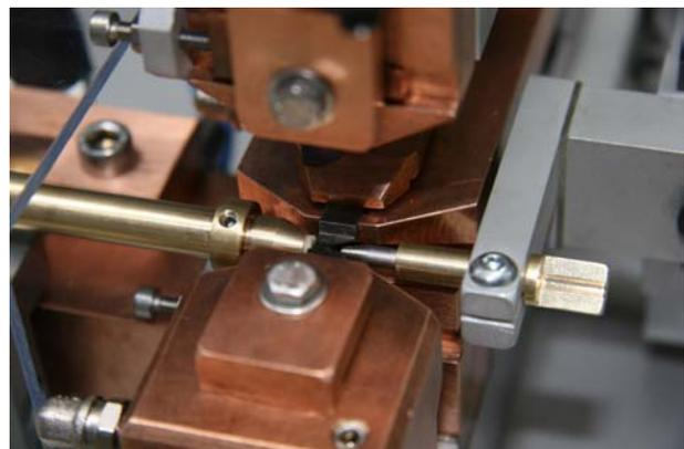
Guide-fil, électrodes et butée de détection
