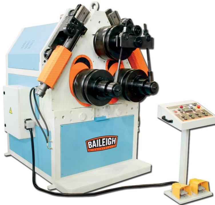
La cintreuse à galets hydraulique BAILEIGH R-H150 dispose d'arbres de galets motorisés de 120 mm de section et les deux galets inférieurs presseurs sont actionnés hydrauliquement et séparément pour une plus grande précision dans le cintrage de grandes sections.
