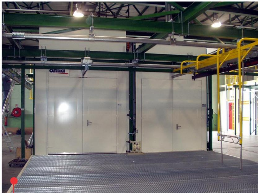
**Cabine d'application pénétrant, rinçage et enceinte de séchage en parallèle avec manutention par transbordeur**
