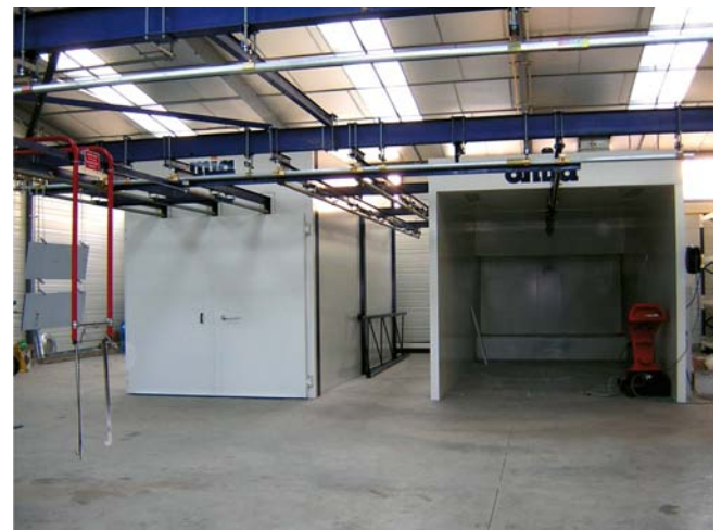
Cabine ouverte avec ventilation horizontale et étuve cuisson, manutention par monorail aérien Open booth with horizontal ventilation and baking oven, handling by aerial monorail
