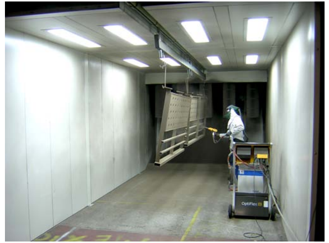
Application en cabine avec convoyeur aérien Application in booth with aerial conveyor
