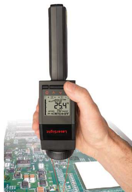
Recherche et développement Mesure de température par infrarouge de haute précision sur des composants SMD. Zone de mesure d'un mm 2 seulement.
