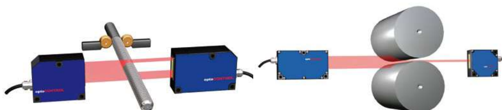
Micromètres utilisés pour contrôler en continu le pas et la hauteur des filetages et le diamètre des barres.
