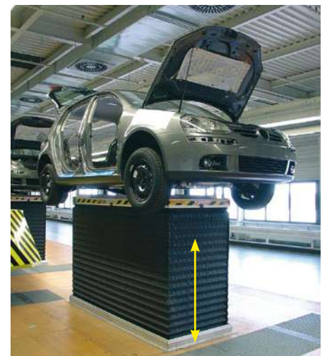
Des capteurs à traction par câble sur spécifications clients en tant que composants OEM clés : les capteurs surveillent la hauteur exacte de levage dans les tables élévatrices utilisées dans l'assemblage automobile.
