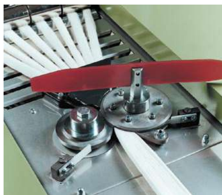
Applications dans les machines textiles mainSENSOR mesure la vitesse de rotation à l'aide d'un petit aimant fixé sur un disque rotatif
