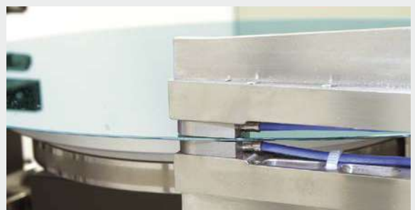
Mesure d'épaisseur des tranches de silicium à l'aide de deux capteurs capacitifs.
