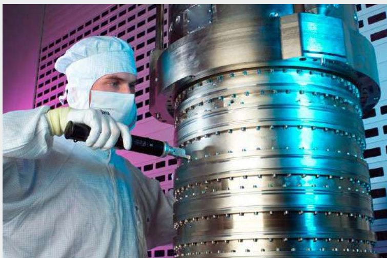
Les capteurs capaNCDT sont utilisés pour procéder à l'ajustement nanométrique des lentilles des objectifs pour l'exposition des tranches de silicium.
