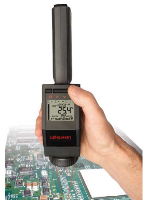
Recherche et Développement Mesure de température par infrarouge de haute précision sur des composants SMD de seulement 1 mm lors de l'essai d'un circuit imprimé.
