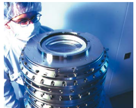
Ajustage au nanomètre près de lentilles dans des objectifs destinés à la réalisation de masques de wafers à l'aide de capteurs de déplacement capacitifs sans contact.
