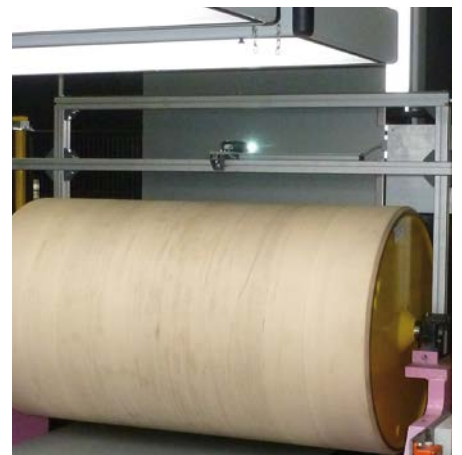
Mesure de couleur sur une bande sans fin revêtue telles que l'aluminium, le zinc ou le papier pendant la production.
