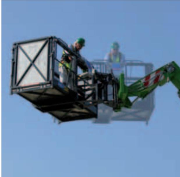
Dans quelques plateformes Merlo, la largeur utile est variable grâce au **système d'extension breveté**, également opérable en hauteur.
