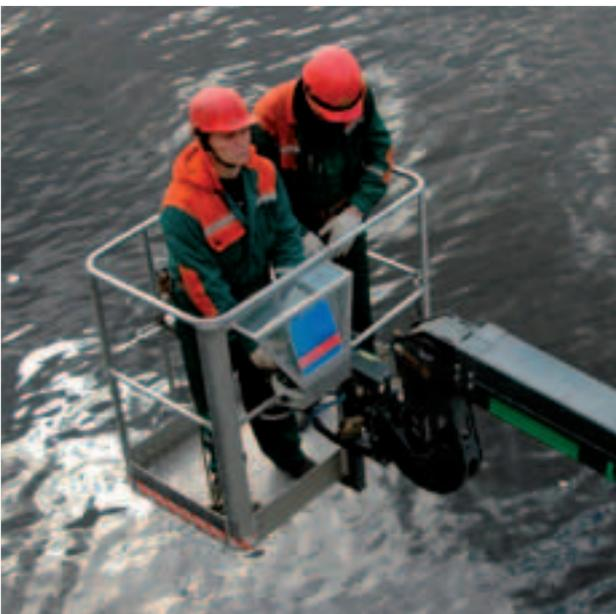
Le Système Space permet d'opérer à une hauteur négative de **plus de 9 mètres sous chaussée**.
