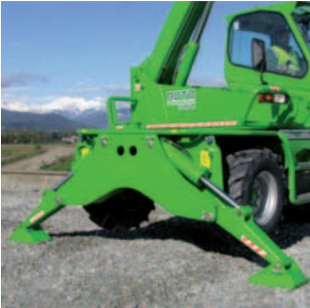
◀ **Stabilisateurs avec positionnement en livre** sur Roto série 400. Ils bénéficient du système Merlo de **mise à niveau automatique**.
