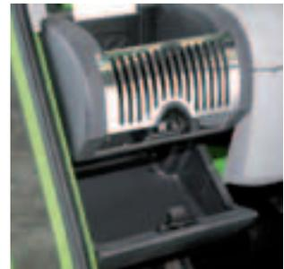
▶ Les **commandes des stabilisateurs et des suspensions hydro-pneumatiques** sont regroupées dans la console latérale.
