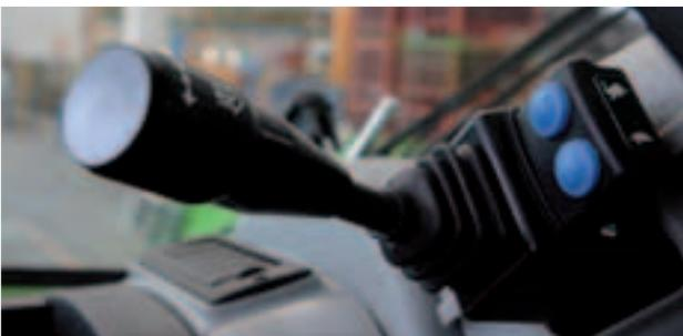
◀◀ La **commande électrique Finger-Touch** permet d'inverser le sens de marche sans enlever les mains du volant. Le **sélecteur de rapport lent ou rapide** est électrique avec une commande à boutons sur Roto MCSS (droite) ou avec un interrupteur basculant sur Roto série 600 et 400 (en bas).
