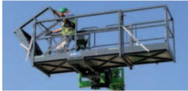
La **rotation hydraulique autour de l'axe vertical** de nombreuses plateformes Merlo permet le travail également avec la machine angulée.
