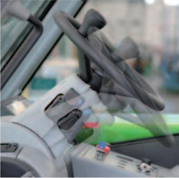
◀ **L'inclinaison du volant** est réglable jusqu'à 16 degrés pour s'adapter aux exigences de conduite.
