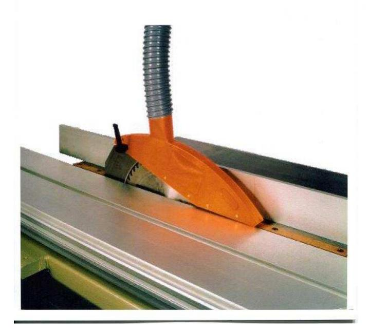
Ce protecteur modèle ALFA NEW, réalisé en polycarbonate, est indiqué pour tout type de scie circulaire équipée d'une lame de diamètre max. 300 mm.
