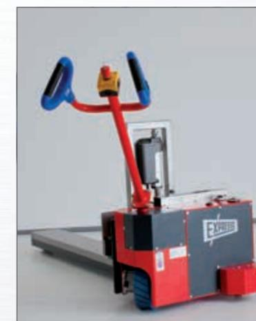
LEO est conçu comme un tracteur de charge. Il associe le concept d'entraînement touch2move EXPRESSO, exclusif et breveté, et les principes des chariots de manutention motorisés guidés par timon.
