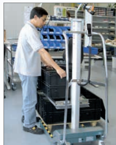
Les stabilisateurs bas glissent sous les palettes
