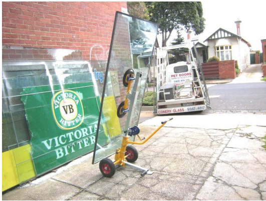
Démontable en 2 éléments de 20 kgs pour le transport
