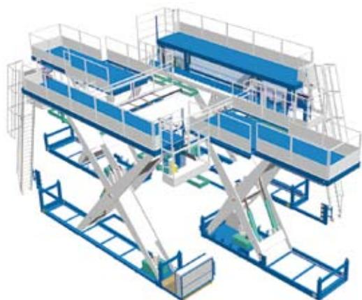
Ces plates-formes élévatrices sont souvent utilisées pour équiper des postes de travail, lorsque le personnel a besoin d'être à des hauteurs variables pour assurer sa fonction dans les meilleures conditions de confort et de sécurité.
